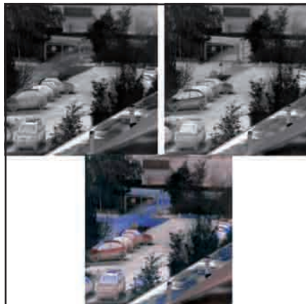
Figura 2: Risultato della fusione DWIR tra immagini MWIR e LWIR ottenute con sensore dual band
