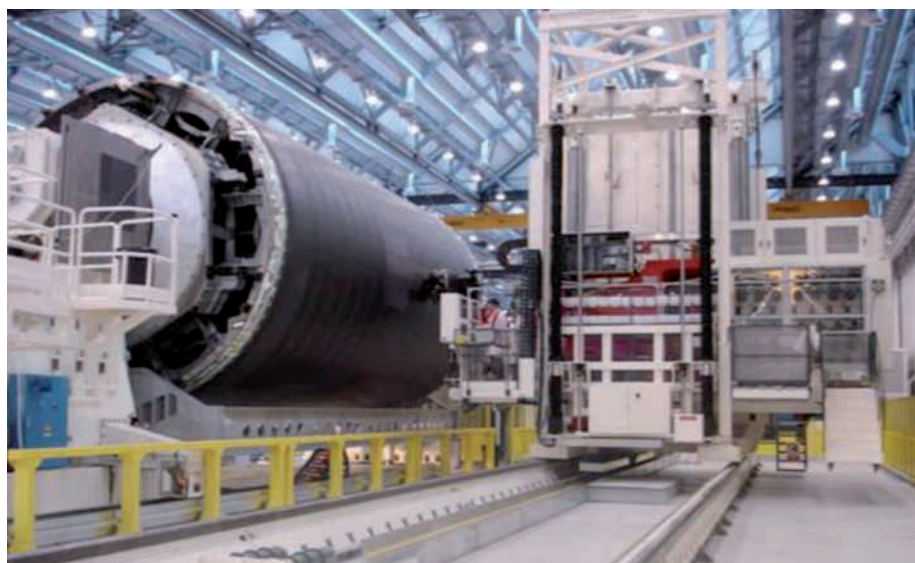
Una sezione di fusoliera del 787, prodotto in composito con advanced fiber placement "cocurato" one shot , in lavorazione presso il sito Alenia Aermacchi a Grottaglie.
