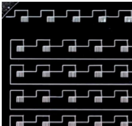
*A sinistra.* Un micrografo mostra una batteria stampata delle dimensioni di un millimetro cubo, con anodi e catodi in una configurazione simile a delle dita.
