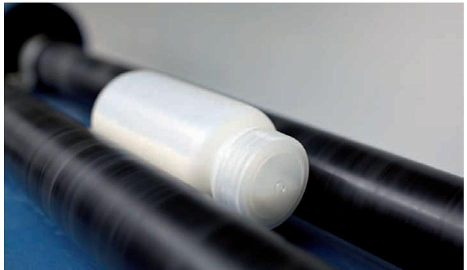
La mistura viene fatta girare per 24 ore e al termine le palline e le particelle più grandi vengono rimosse utilizzando filtri e un'azione centrifuga.
