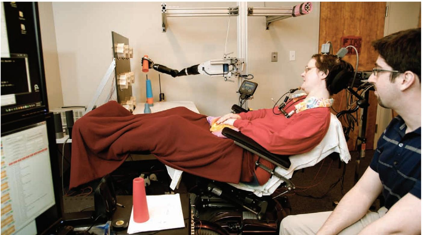
Jan Scheuermann impila coni con un braccio robotico controllato dalla sua mente, sotto il controllo dell'assistente alla ricerca Brian Wodlinger.
