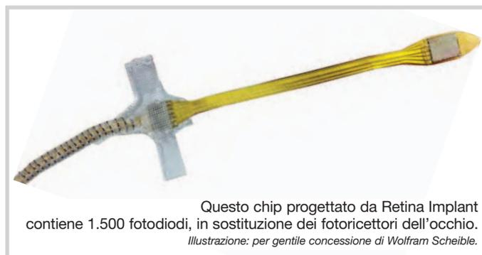
Questo chip progettato da Retina Implant contiene 1.500 fotodiodi, in sostituzione dei fotorecettori dell'occhio. Illustrazione: per gentile concessione di Wolfram Scheible.
